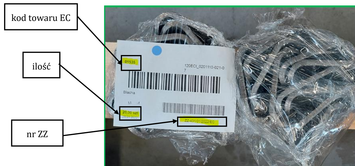
Rysunek 3. Prawidłowa etykieta dołączona do detali.
