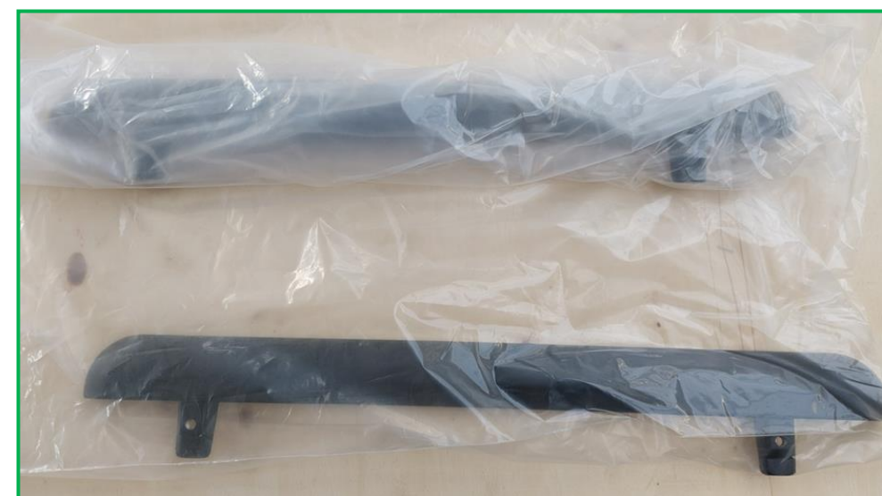
Rysunek 4. Odpowiednio zabezpieczona powłoka malowana do transportu.
