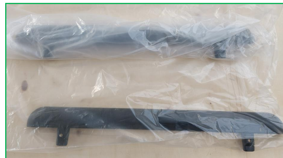
Rysunek 4. Odpowiednio zabezpieczona powłoka malowana do transportu.
