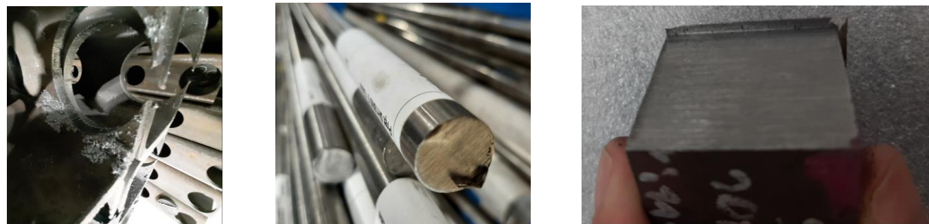
Rysunek 6. Przykłady niezgodnej dostawy - brak oczyszczenia materiału ciętego.
