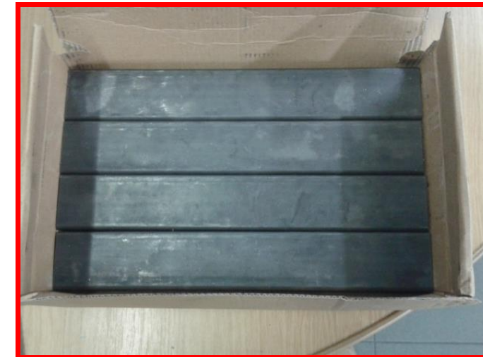
Rysunek 2. Błędne oznakowanie - brak numeru zamówienia/detalu.
