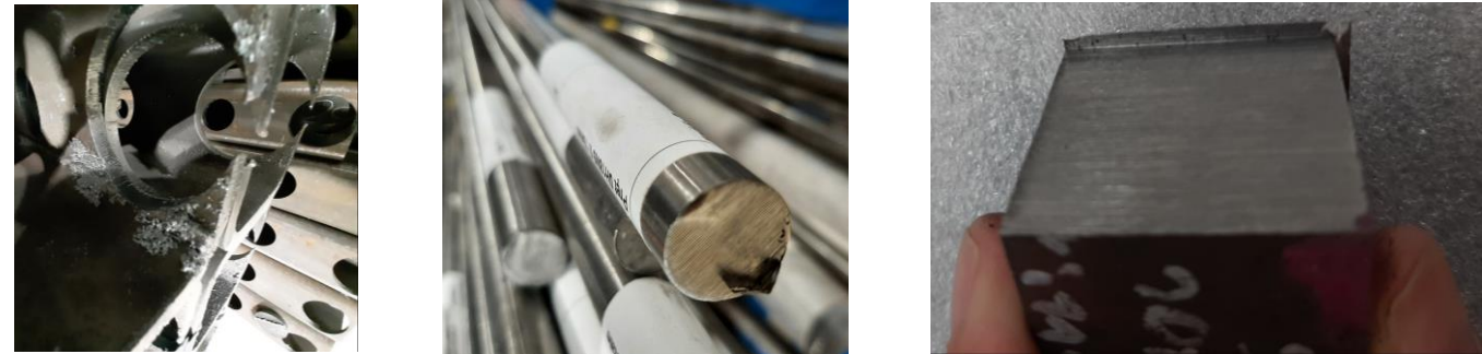
Rysunek 6. Przykłady niezgodnej dostawy - brak oczyszczenia materiału ciętego.
