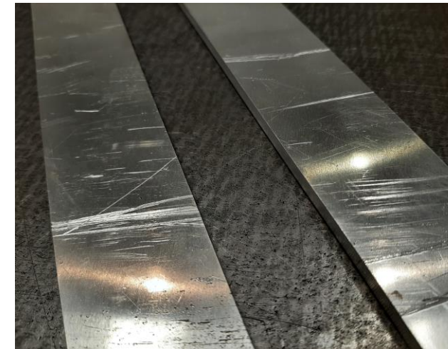
Rysunek 3. Przykłady niezgodnej dostawy - brak zabezpieczenia materiału w dostawie.
